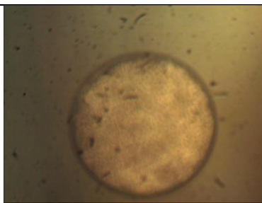
4. att. Al maska 0,4 μm noņemta no SiO 2 5 μm
