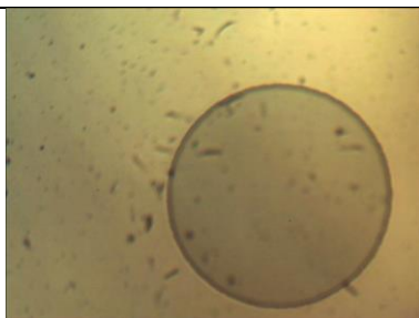
3. att. SiO 2 kodināšanas paraugs 5 μm biezs (šķidruma tralēšana) ar Al masku 1 μm biežumā. Maska noņemta.
